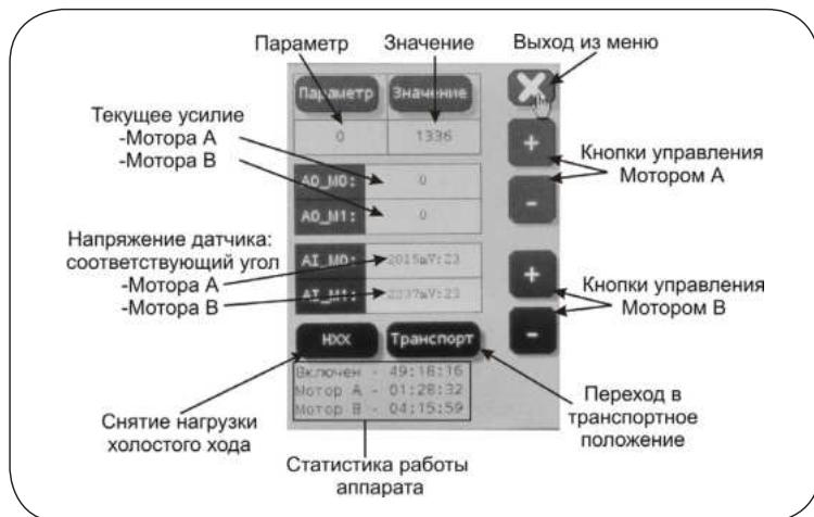
Рисунок 5.7 – Дисплей режима настройки системы
